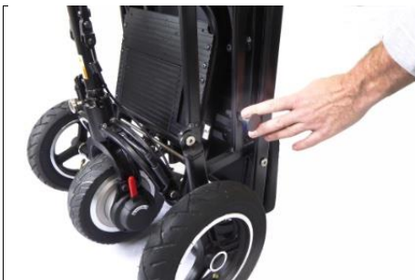
5 Lokalisieren Sie den kleinen schwarzen Stopper an der Seite und ziehen Sie daran, um die Vorderradbaugruppe zu lösen.
