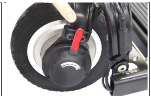
12 Vergewissern Sie sich, dass sich die Magnetbremse in der VERRIEGELTEN Position befindet, um den Motor einzukuppeln.
