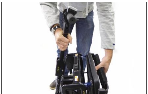
6 Halten Sie die Lenksäule und die Sitzlehne fest und ziehen Sie sie auseinander ...
