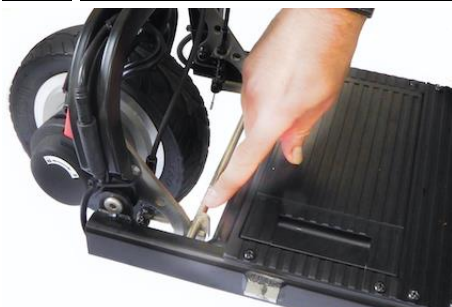
10 Stellen Sie sicher, dass die Verriegelungsklinken an der Stahlstange eingerastet sind...
