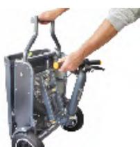
Presione la columna de dirección en el bastidor hasta que se bloquee el pestillo «E».
