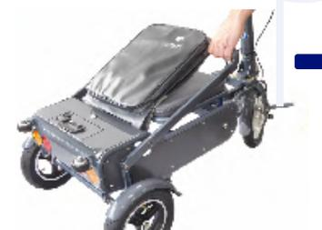
Baje el asiento y coloque los reposapiés en posición vertical.
