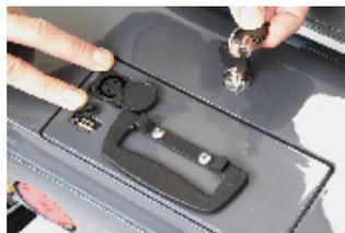
Para cargarla, conecte el cable de alimentación al puerto de carga situado en la batería. También hay un puerto USB para cargar y alimentar un teléfono móvil.
