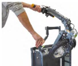
Baje la columna de dirección sobre el asa de transporte.
