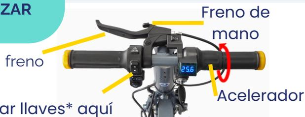
Para encender el scooter, inserte la llave y gírela en el sentido de las agujas del reloj desde la posición de las 9 a las 11. El acelerador está situado en la empuñadura derecha. El freno es manual y se encuentra junto a la empuñadura izquierda. El voltaje se muestra en la pantalla digital, recuerde recargar cada 3 meses o cuando el indicador muestre 24v o menos.
