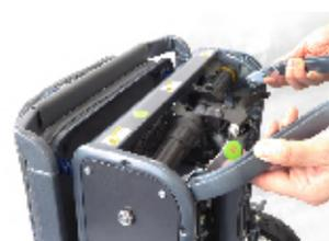
Presione y mantenga presionados los pestillos «B» y «C» y pliegue el asa de transporte hacia abajo.
