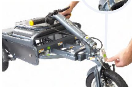
Appuyer sur le loquet « A » et le relâcher, en rabattant la colonne de direction à plat contre le siège.
