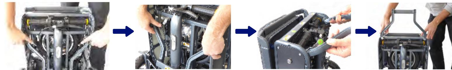
Localisez les loquets « B » et « C ». Appuyez sur ces loquets et tirez la poignée de traînage/transport en position verticale.
