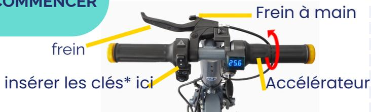
**Pour mettre le scooter en marche**, insérez la clé et tournez-la dans le sens des aiguilles d'une montre, de la position 9 à 11 heures. L'accélérateur se trouve sur la poignée droite. Le frein est manuel et se trouve à côté de la poignée gauche. La tension est indiquée sur l'écran numérique. N'oubliez pas de recharger le scooter tous les 3 mois ou lorsque la jauge affiche 24 V ou moins.
