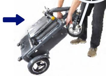
Soulevez le scooter en position verticale et verrouillez la roue avant à plat sur son aimant dans le cadre.
