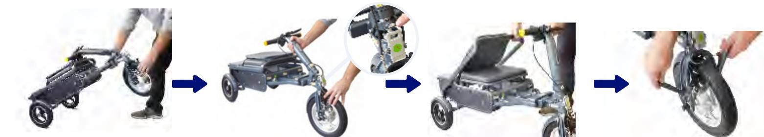
Tirez la roue vers l'avant et abaissez le scooter avec précaution sur le sol.
