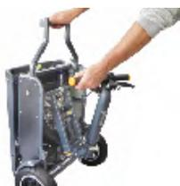
Pousser la colonne de direction dans le cadre jusqu'à ce que le loquet « E » se verrouille.
