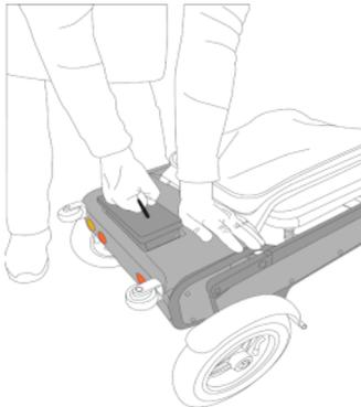
**Nota:** Asegúrese de que la batería esté **DESBLOQUEADA** con la llave suministrada antes de intentar retirarla. Consejos para prolongar el rendimiento y la vida útil de la batería. Si la batería no se utiliza a menudo, es preferible darle una breve carga cada 2-3 meses. La batería debe cargarse lo antes posible después de cada uso. No almacene nunca la batería muy descargada.
