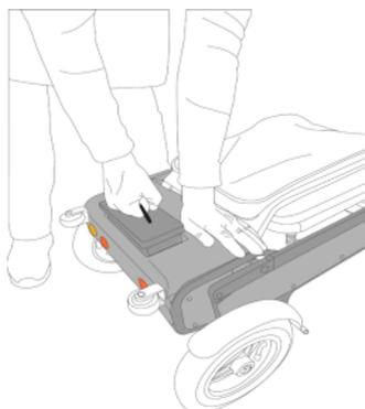
**NB : Avant de tenter d'enlever la batterie, assurez-vous qu'elle est DÉVERROUILLÉE à l'aide de la clé fournie. Conseils permettant d'optimiser les performances et la durée de vie de la batterie. Si la batterie n'est pas utilisée régulièrement, il est recommandé de la recharger de temps en temps (tous les 2 ou 3 mois, par exemple). Après chaque utilisation, la batterie doit être rechargée le plus tôt possible. Ne stockez jamais la batterie en état de forte décharge.**
