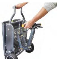
Premere il piantone dello sterzo nel telaio finché il fermo "E" non si blocca.
