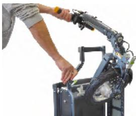
Abbassare il piantone dello sterzo sulla maniglia di trasporto.
