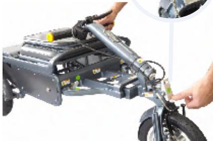
Premere e rilasciare il fermo "A", ripiegando il piantone dello sterzo contro il sedile.
