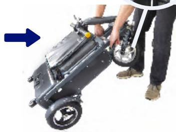
Sollevare il monopattino in posizione verticale e bloccare la ruota anteriore in piano sul suo magnete nel telaio.
