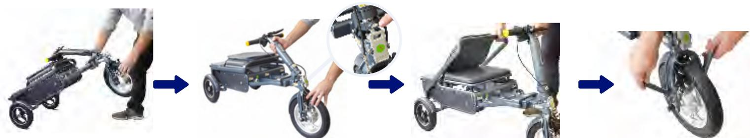
Tirare la ruota in posizione anteriore e abbassare con cautela lo scooter a terra.
