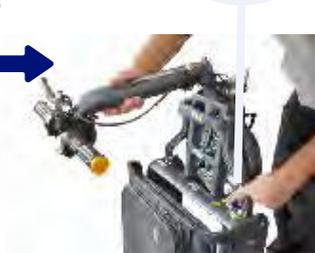
Localizar o trinco "D" e pressionar enquanto se apoia a coluna de direção.
