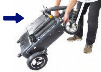
Levante a scooter para uma posição vertical e bloqueie a roda dianteira no seu íman na estrutura.
