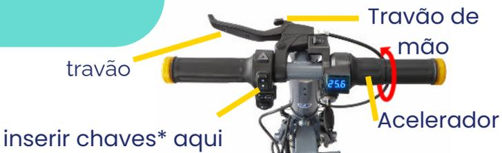
**Para ligar a scooter,** introduza a chave e rode no sentido dos ponteiros do relógio da posição das 9 às 11 horas. O acelerador rotativo encontra-se no punho direito. O travão é manual e está localizado ao lado do punho esquerdo. A tensão é mostrada no ecrã digital, lembre-se de recarregar a cada 3 meses ou quando o indicador mostrar 24v ou menos.
