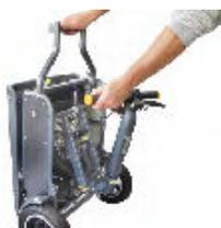
Pressionar a coluna de direção para dentro da estrutura até que o trinco "E" bloqueie.
