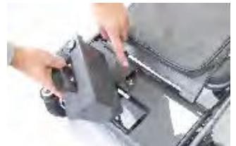
**Če želite polniti,** priključite napajalni kabel na vrata za polnjenje na bateriji. Na voljo je tudi vhod USB za polnjenje in napajanje mobilnega telefona.
