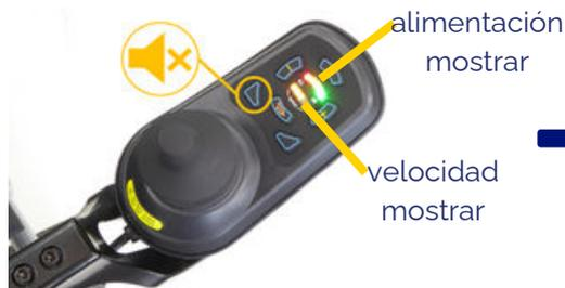
El mando dispone de botones para ajustar la velocidad, con 5 niveles de potencia y 5 ajustes de velocidad (1 = baja, 5 = alta).
