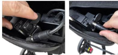
Conecta el cable de alimentación a la batería deslizando la tapa del puerto e insertando el cable de alimentación.
