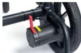
Las palancas de freno rojas se colocan en la posición hacia delante, que engrana el motor. Para el modo de rueda libre, tire de ambas palancas hacia atrás.
