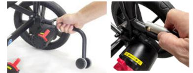
Inserte las ruedas antivuelco en la parte posterior del armazón de la silla con los botones elásticos hacia dentro.
