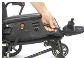
Inserire l'asta del joystick sotto il bracciolo e serrare saldamente la manopola.
