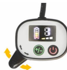
Il comando dell'assistente regola la velocità di deambulazione per l'assistente e fornisce un controllo della batteria, con una leva per il movimento in avanti e all'indietro.
