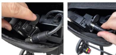
Collegare il cavo di alimentazione alla batteria facendo scorrere il coperchio della porta e inserendo il cavo di alimentazione.
