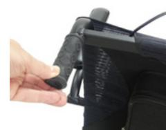
Installare le maniglie dell'accompagnatore avvitandole nella parte superiore del telaio della sedia.
