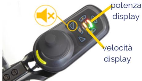
Il telecomando dispone di pulsanti per la regolazione della velocità, con 5 livelli di potenza e 5 impostazioni di velocità (1 = bassa, 5 = alta).
