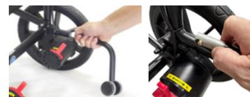
Inserire le ruote antiribaltamento nella parte posteriore del telaio della sedia con i bottoni a pressione rivolti verso l'interno.
