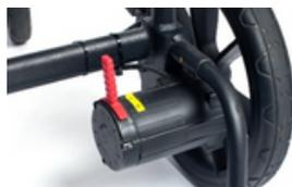
Le leve rosse del freno sono posizionate in avanti, in modo da bloccare il motore. Per la modalità a ruota libera, tirare entrambe le leve in posizione arretrata.
