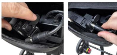
Ligue o cabo de alimentação à bateria fazendo deslizar a tampa da porta e inserindo o cabo de alimentação.
