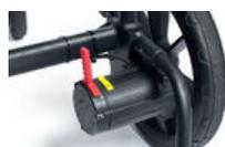
As alavancas de travão vermelhas estão colocadas na posição para a frente, o que engata o motor. Para o modo de roda livre, puxe ambas as alavancas para a posição de trás.
