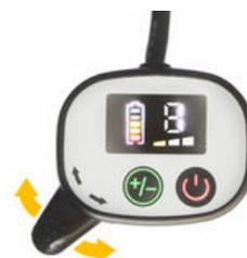
O controlo do assistente ajusta a velocidade de marcha para o seu assistente e permite verificar a bateria, com uma alavanca para avançar e recuar.
