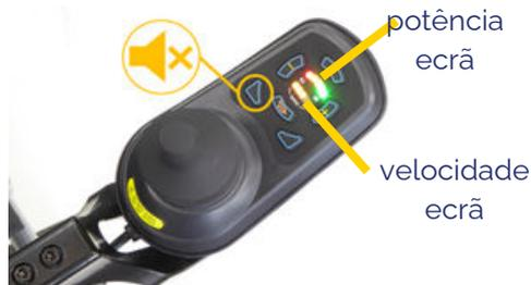
O controlador do auscultador possui botões para ajustar a velocidade, com 5 níveis de potência e 5 definições de velocidade (1 = baixa, 5 = alta). Para desativar o som de inversão, basta premir o botão (mostrado acima).
