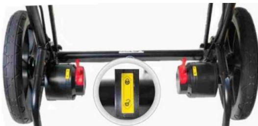
Coloque las manijas de freno rojas del modo de rueda libre (signo desbloqueado) a la posición de conducción (señal bloqueado), para volver a encender ambos motores.
