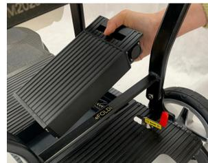
**Um den Akku zu entfernen,** heben Sie die Verriegelung an und ziehen Sie ihn vorsichtig nach oben. Der Ladeanschluss befindet sich auf der Seite des Akkus.
