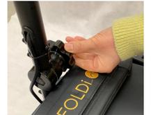
Vergewissern Sie sich, dass das Zahnrad gelockert ist (gegen den Uhrzeigersinn) und eine Lücke zwischen den Zähnen des Scharniers besteht.
