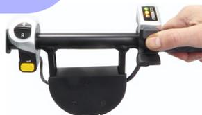
**Um den Roller einzuschalten,** drücken Sie die graue Taste unter dem Batteriebildschirm. Wählen Sie (D) für Fahren oder (R) für Rückwärtsfahren, und drücken Sie dann den Daumengashebel, um loszufahren. Achten Sie darauf, die Batterie wieder aufzuladen, wenn die Anzeige gelb leuchtet.
