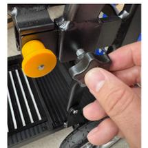
Setzen Sie die Armlehnen ein, richten Sie sie aus und ziehen Sie sie mit den großen, griffigen Drehknöpfen fest.
