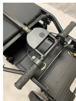
Lösen Sie die Lenksäule durch Drehen des Riegels (gegen den Uhrzeigersinn).
