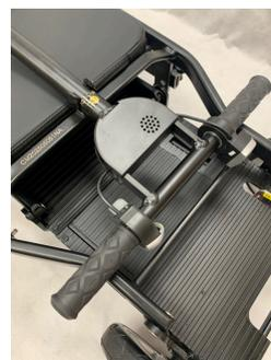
Débloquer la colonne de direction en tournant la roue dentée (dans le sens inverse des aiguilles d'une montre).
