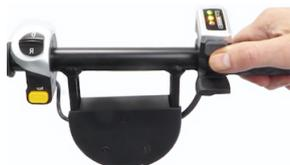
**Pour allumer le scooter,** appuyez sur le bouton gris situé sous l'écran de la batterie. Sélectionnez (D) pour la conduite ou (R) pour la marche arrière, puis appuyez sur l'accélérateur pour démarrer. Veillez à recharger la batterie lorsque l'écran affiche l'ambre.
