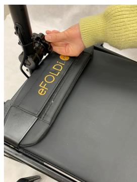
Fixez la colonne de direction en tournant la roue dentée (dans le sens des aiguilles d'une montre). Vous pouvez positionner la colonne de direction en fonction de votre portée et de votre confort.
