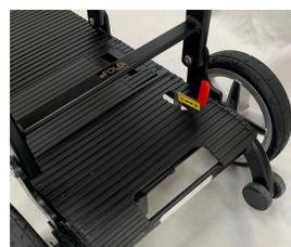
Vérifiez que le levier rouge du frein magnétique est en position VERROUILLÉE (vers l'arrière) pour engager le moteur.
