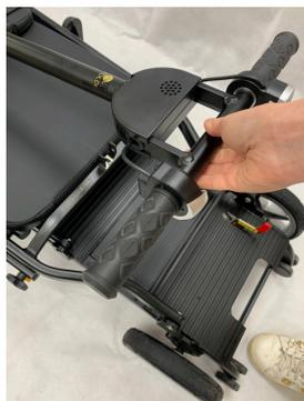
Dégager la colonne de direction du clip en plastique et la soulever en position verticale.
