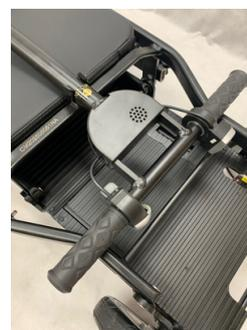
Rilasciare il piantone dello sterzo ruotando l'ingranaggio (in senso antiorario).
