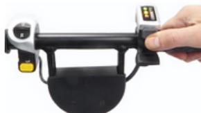
**Per accendere lo scooter,** premere il pulsante grigio sotto la schermata della batteria. Selezionare (D) per la guida o (R) per la retromarcia, quindi premere l'acceleratore a pollice per partire. Assicurarsi di ricaricare la batteria quando il display mostra il colore ambra.
