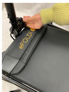
Fissare il piantone dello sterzo ruotando l'ingranaggio (in senso orario). È possibile posizionare il piantone dello sterzo in modo da adattarlo al proprio raggio d'azione e al proprio comfort.
