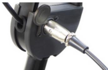
**Per la ricarica,** collegare il cavo di alimentazione alla porta di ricarica situata nella parte superiore del piantone dello sterzo.
