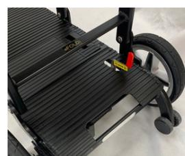
Verificare che la leva rossa del freno magnetico sia in posizione LOCKED (indietro) per bloccare il motore.
