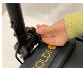
Assicurarsi che il piantone dello sterzo sia fissato saldamente; in caso contrario, serrare l'ingranaggio.
