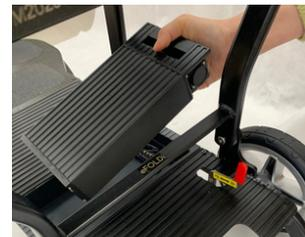
**Per rimuovere la batteria,** sollevare il fermo e tirarla con cautela verso l'alto. La porta di ricarica si trova sul lato di la batteria.
