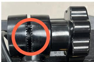
Verificar se a roda dentada está desapertada (no sentido contrário ao dos ponteiros do relógio) e se existe um espaço entre os dentes da dobradiça.
