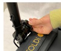
Fixe a coluna de direcção rodando a roda dentada (no sentido dos ponteiros do relógio). Pode posicionar a coluna de direcção de acordo com o seu alcance e conforto
