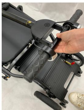
Solte a coluna de direcção do clipe de plástico e levante-a para a posição vertical.
