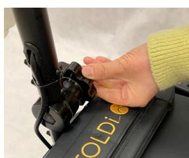
Certifique-se de que a coluna de direcção está bem fixada; se não estiver, aperte a roda dentada.
