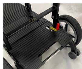
Verifique se a alavanca vermelha do travão magnético está na posição LOCKED (para trás) para engatar o motor.
