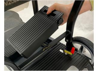
**Para retirar a bateria,** levante o trinco e puxe-o cuidadosamente para cima. A porta de carregamento está localizada na parte lateral da bateria.
