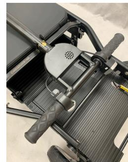
Soltar a coluna de direcção rodando a roda dentada (no sentido contrário ao dos ponteiros do relógio).
