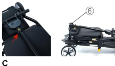
**C** Afloje la perilla de bloqueo del vástago de la dirección (6) girándola en sentido contrario a las agujas del reloj. Presione el manillar hacia abajo en la ranura de bloqueo fijo y apriete la perilla de bloqueo de nuevo para que deje de moverse.
