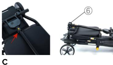
**C** Desserrez le bouton de verrouillage de la tige de direction (6) en le tournant dans le sens inverse des aiguilles d'une montre. Appuyez sur le guidon vers le bas dans la fente de verrouillage fixe et serrez à nouveau le bouton de verrouillage pour l'empêcher de bouger.
