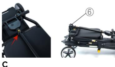
**C** Allentare la manopola di bloccaggio dell'asterzo (6) ruotandola in senso antiorario. Premi il manubrio verso il basso nella fessura di bloccaggio fissa e stringi di nuovo la manopola di bloccaggio per impedirgli di muoversi.
