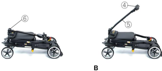
**A** Posizionare lo scooter eFOLDi in orizzontale e rilasciare la manopola di bloccaggio dell'asterzo (6).
