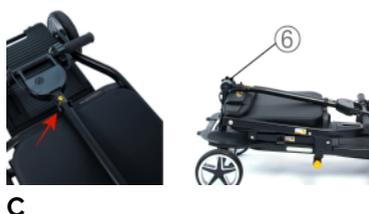
**C** Solte o botão de travamento da haste de direção (6) girando-o no sentido anti-horário. Pressione o guidão para baixo na ranhura de travamento fixa e aperte o botão de travamento novamente para impedi-lo de se mover.
