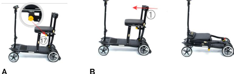
**A** Puxe o pino de tração (17) para fora e dobre a estrutura do encosto (1) em direção à haste de direção.
