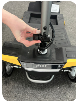
Otočte ozubeným kolečkem na říditkách, aby se říditka sklopila do vodorovné polohy
