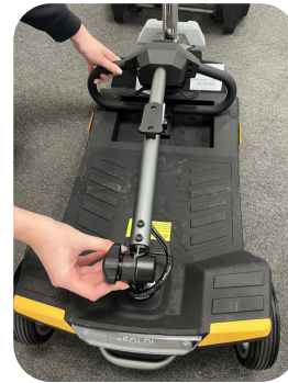
Otočte ozubeným kolečkem na říditkách, aby se říditka sklopila do vodorovné polohy
