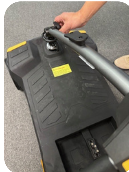
Otočte ozubeným kolečkem na říditkách, aby se říditka sklopila do vodorovné polohy
