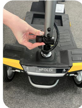
Drehen Sie das Ruderrad, um das Ruder abzusenken, bis es flach aufliegt.
