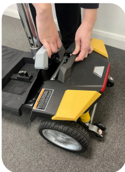
Heben Sie den grauen Griff an, um den hinteren Teil abzunehmen
