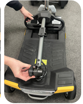
Drehen Sie das Ruderrad, um das Ruder abzusenken, bis es flach aufliegt.
