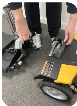
Levanta el asa gris para separar la sección trasera
