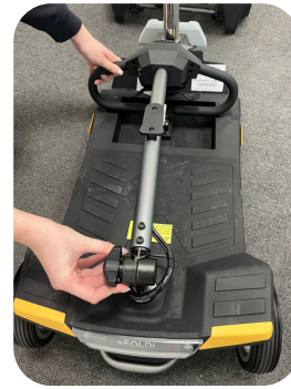
Gira la rueda de la barra de dirección para bajarla hasta que quede en posición horizontal.
