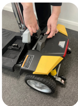
Levanta el asa gris para separar la sección trasera
