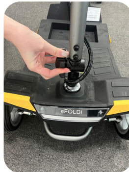
Gira la rueda de la barra de dirección para bajarla hasta que quede en posición horizontal.
