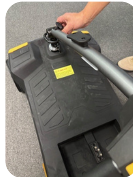
Gira la rueda de la barra de dirección para bajarla hasta que quede en posición horizontal.
