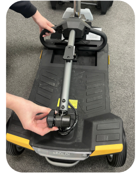
Vrid ratten för att fälla ner ratten tills den ligger plant
