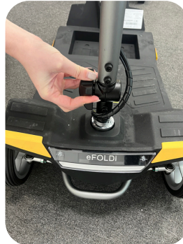
Vrid ratten för att fälla ner ratten tills den ligger plant
