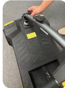
Vrid ratten för att fälla ner ratten tills den ligger plant
